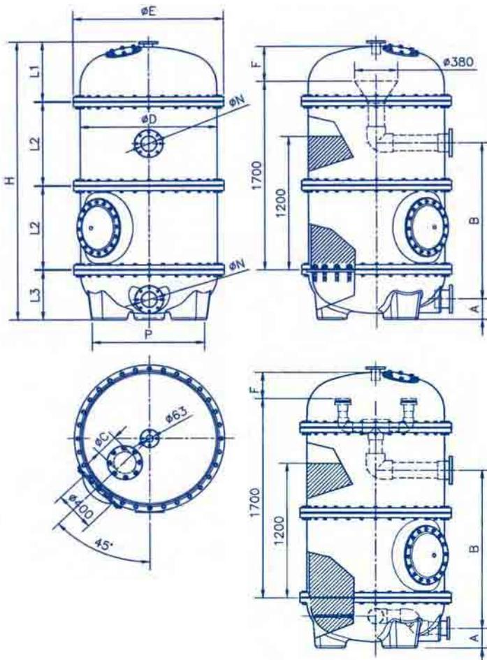
Общие размеры фильтров моделей DIN Split и HP Split (высота фильтрующего слоя 1,2 м)
