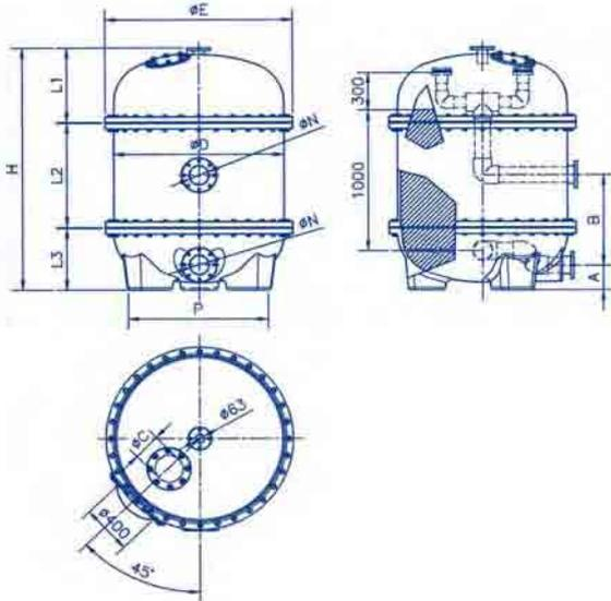
Общие размеры фильтров моделей 1м НВ Split (высота фильтрующего слоя 1 м)
